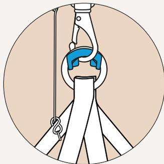
Für die Wiege wird die Nylonschnur um die verstellbaren Gurte der Wiege gelegt, ca. 7 cm vom Metallring entfernt. Befestige den S-Haken um die Nylonschnur, um es zu spannen.
